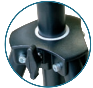
Chariot en aluminium coulé avec molette de serrage sur cale polyamide et bague téflon pour un coulisement parfait. Double verrouillage avec goupille de sécurité
